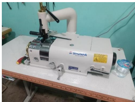
Gambar 5 Mesin seset yang diinstal
