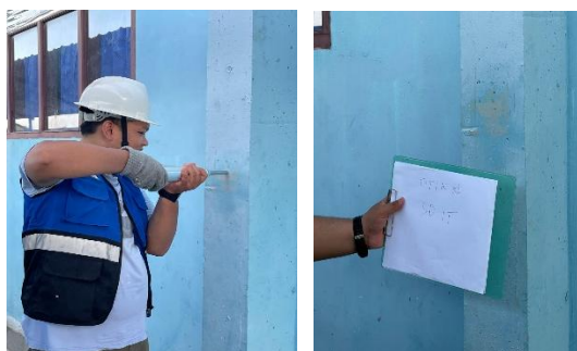
Gambar 9 Dokumentasi hammer test
