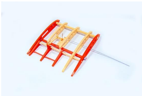
Gambar 5. Miniatur sayap dan aileron pesawat terbang yang dicetak menggunakan teknologi 3D.
