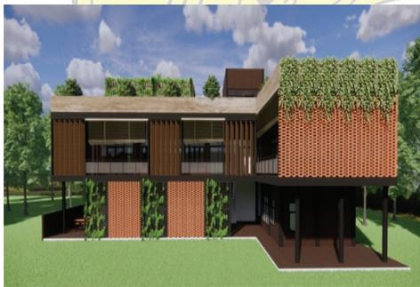
Gambar 4. Penerapan *Secondary Skin* Pada Bagian Depan Fasad Bangunan.
