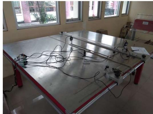
Gambar 2. Setup Perangkat Konversi Data di Meja Ukur
