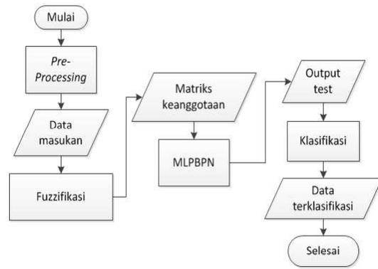
Gambar. 1. Diagram alir sistem Neuro-Fuzzy secara umum
