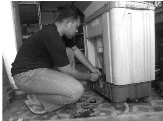
Gambar 1. Aktivitas pemeriksaan instalasi kabel mesin cuci
